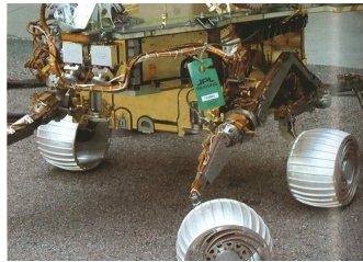
Suspensión "Rocker-bogie" 6 ruedas; dirección sólo 4
