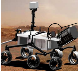
Mecanismo de Apuntamiento Automático de la Antena de Alta Ganancia del Mars Science Laboratory (SENER, España)
