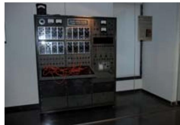
Fig. 2. Analizador diferencial analógico. Primer computador construido en España, 1954.
