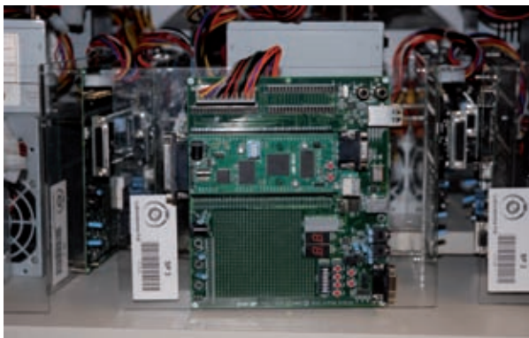
Fig. 15. Placa de desarrollo con FPGA
